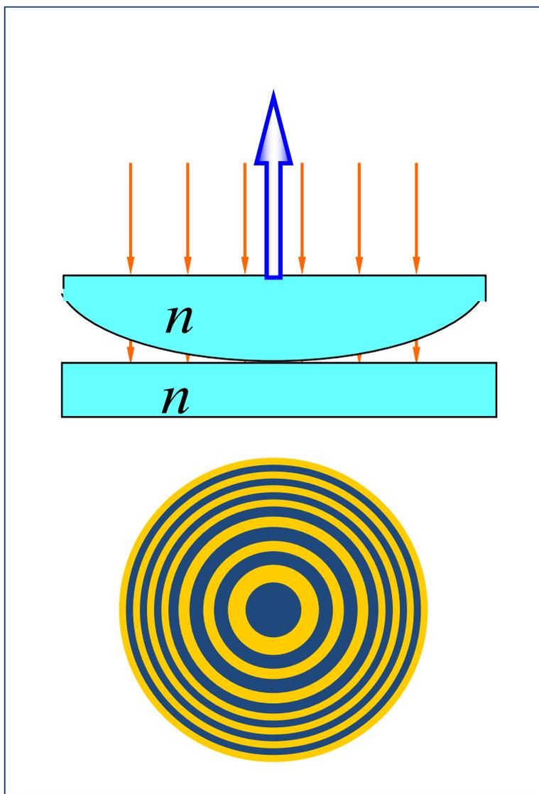
**例** 如图，用单色光垂直照射在观察牛顿环的装置上，当平凸透镜垂直向上缓慢平移远离平面玻璃时，可以观察到这些环状干涉条纹
